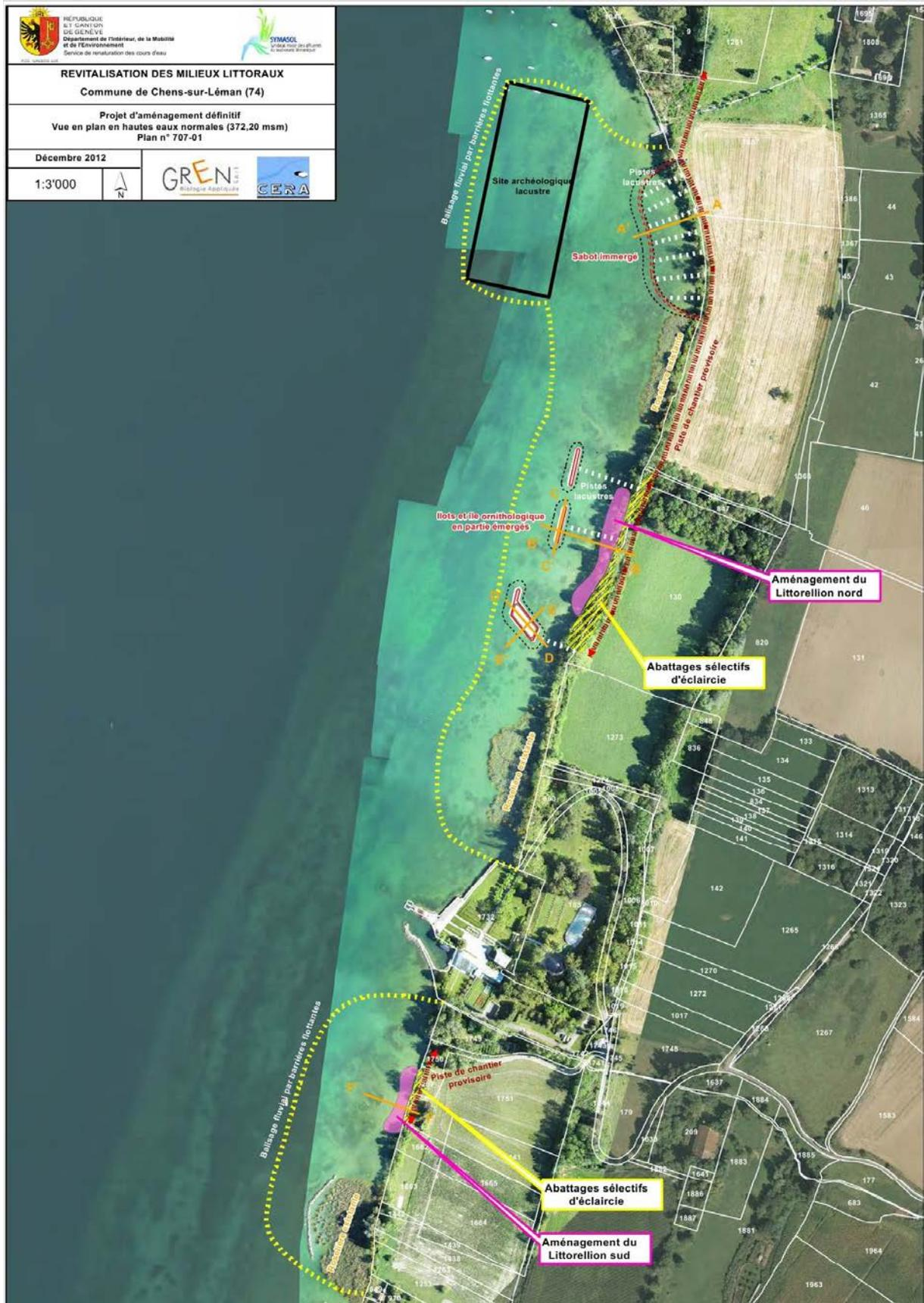
Figure 60: Chens-sur-Léman. Aménagement de milieux aquatiques et d'îlots pour les oiseaux, projet définitif (GREN et CERA, 2012). Description des ouvrages et profils en travers (rapport en annexe, sur CD).
