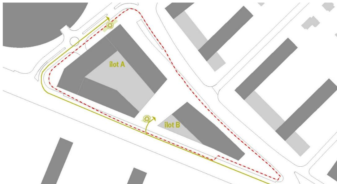
Figure 32 : Localisation des points de collecte des déchets du périmètre du PLQ Pointe du Bouchet
