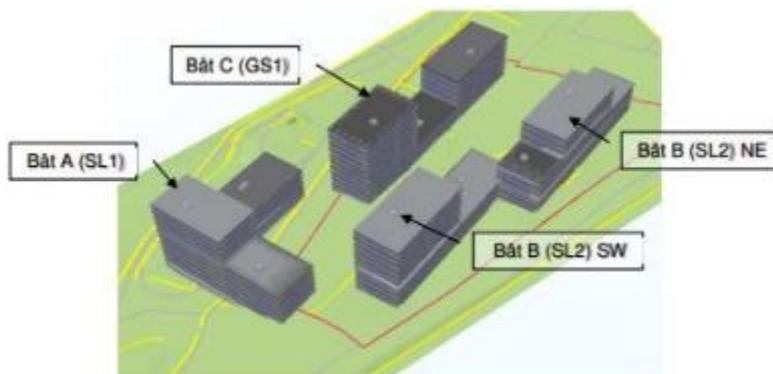
Compte tenu de la présence de la nappe du Grand-Saconnex, la réalisation du projet devrait au droit des bâtiments A et C intercepter cette nappe. Dès lors un radier s'impose et les sous-sols devront être conçus comme une construction étanche ; un drainage des murs extérieurs au-dessus de la nappe est possible.
