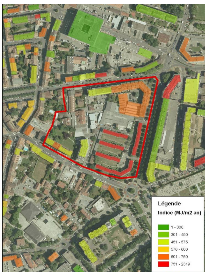
Figure 9 : Moyenne de l'indice de dépense énergétique des deux dernières années (MJ/m 2 .an, 2009)
