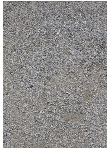
Revêtement placette 2: Perméable, accessible PMR (ex.: gravier stabilisé)
