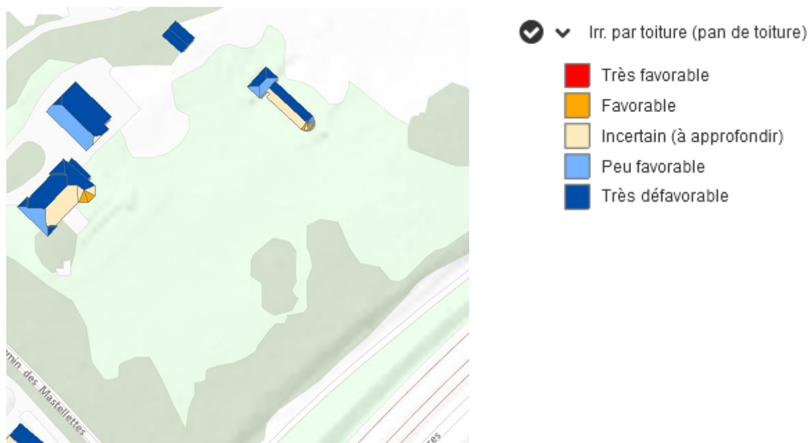
Figure 7: Irradiation solaire en toiture, source : SITG
