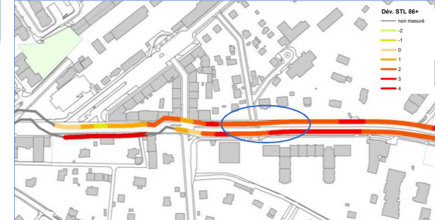
Déviations pour les véhicules légers par rapport au modèle STL 86+ suite aux mesures CPX
