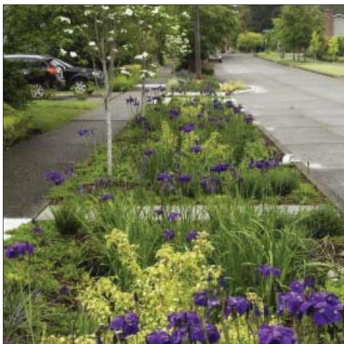
Figure 21 Exemple d'une noue (source OCEau).
