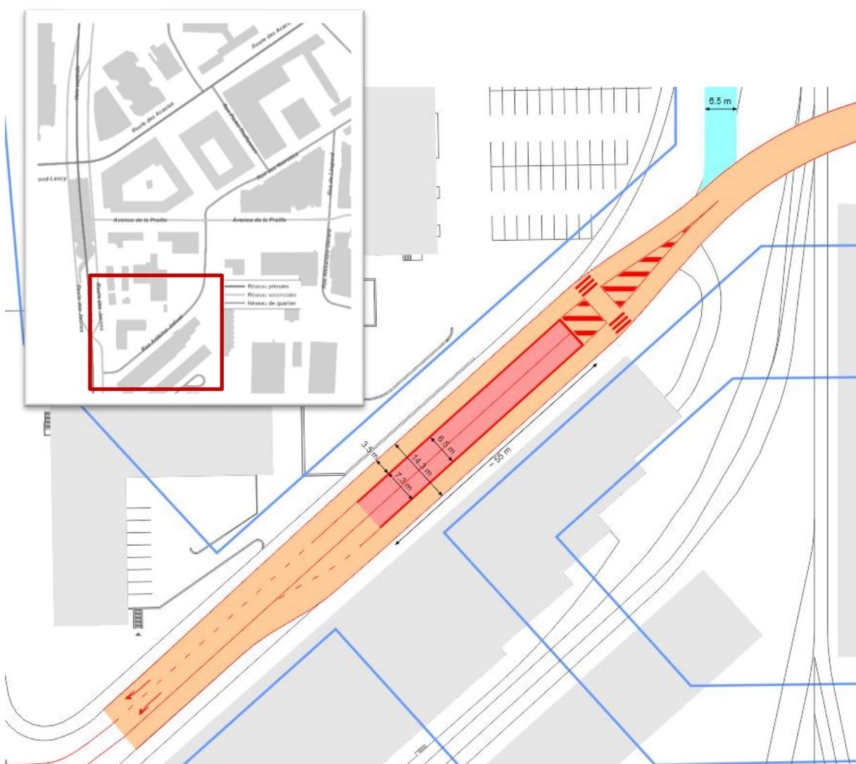
Figure 22 Configuration de la rampe du parking centralisé (provisoire) sur la rue Antoine-Jolivet
