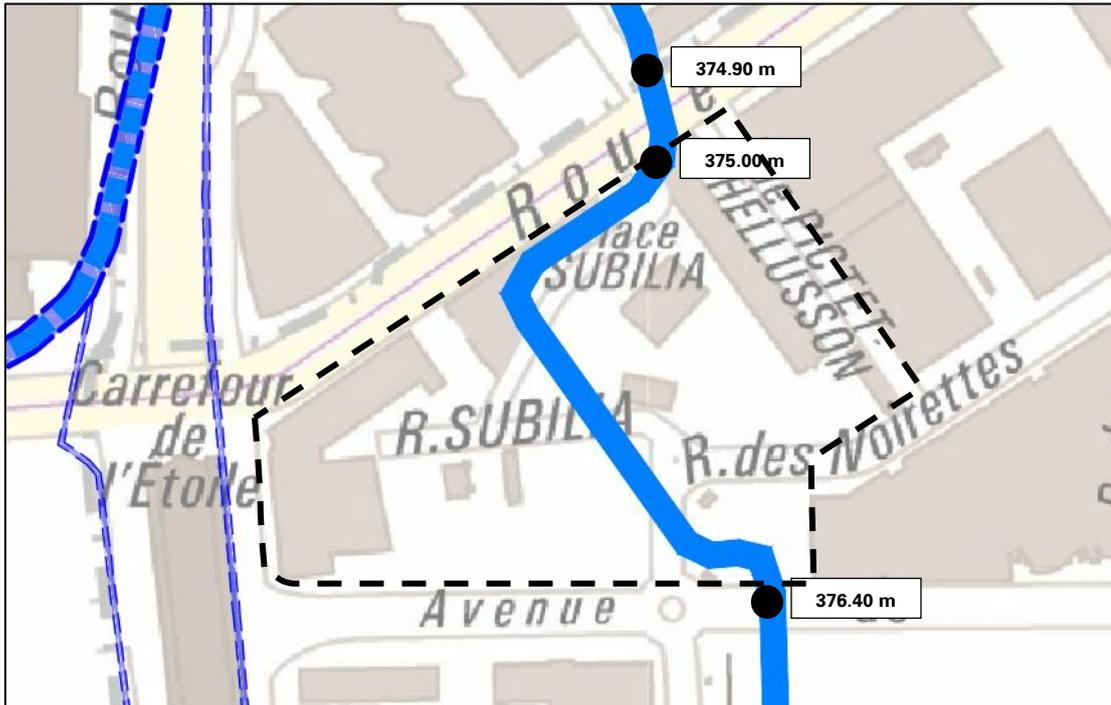
figure 14 Tracé projeté de la Drize dans le périmètre du PLQ et niveau du lit
