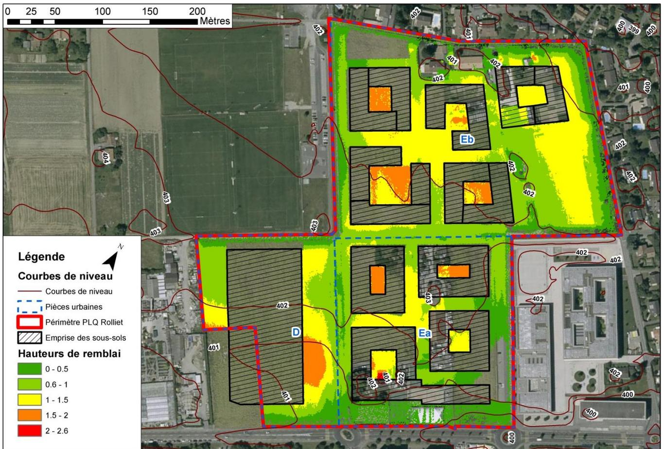
Figure 5 : Hauteurs de remblai lié au remodelage prévu par le PDQ
