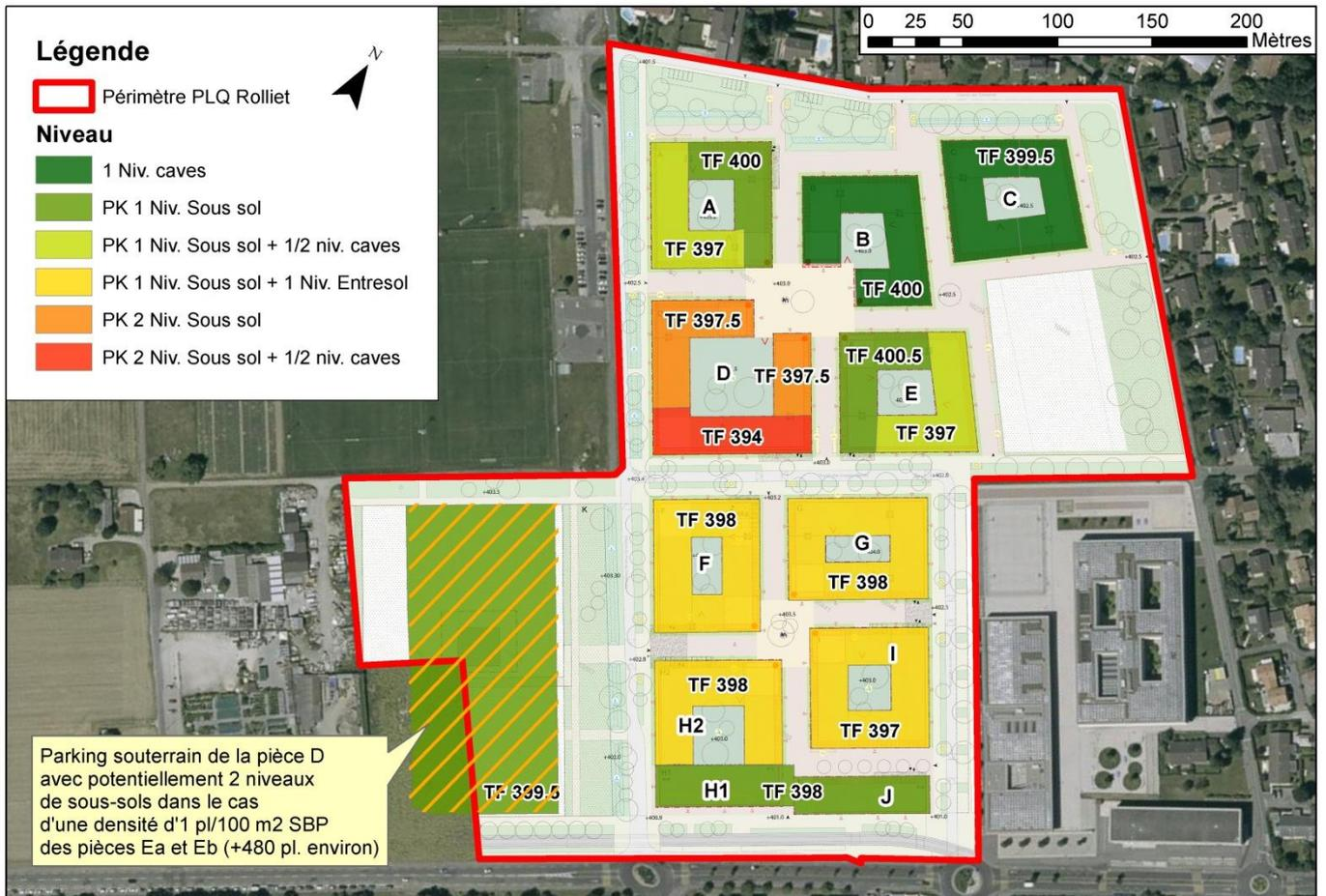
Figure 9 : Emprises et niveaux des souterrains – remodelage PDQ et densité de parkings de 0.6 pl/100 m2 SBP
