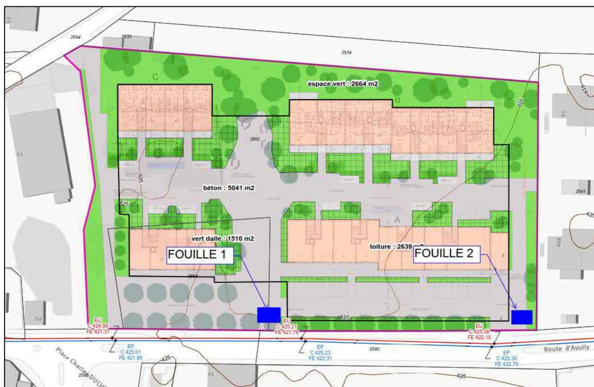
Figure 5 : Position des deux essais d'infiltrations effectués le 03.11.2016
