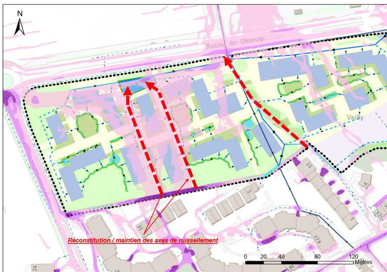
Figure 18 - Intégration d'axes de ruissellement de surface
