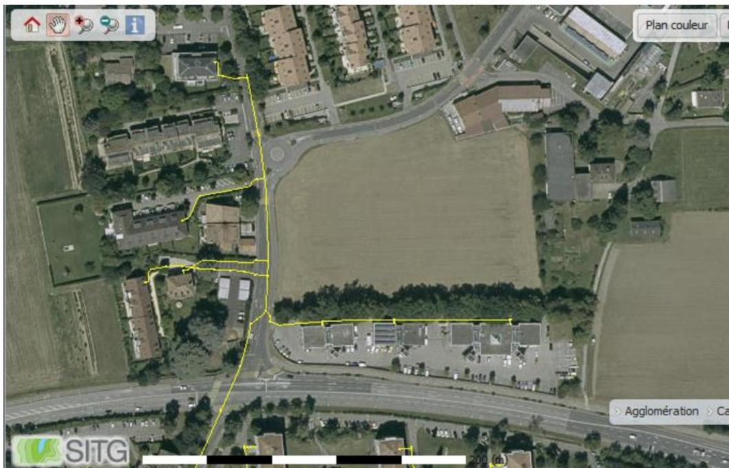
Figure 11 : Tracé du réseau de gaz (en jaune) sur la zone d'étude (source : SITG, cadastre technique du sous-sol)
