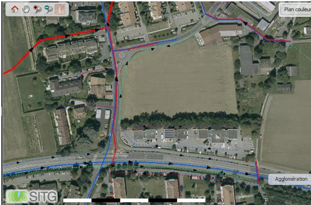
Figure 12 : Tracés des collecteurs d'assainissement (en bleu : eaux pluviales, en rouge : eaux usées) (source : SITG, réseau d'assainissement)
