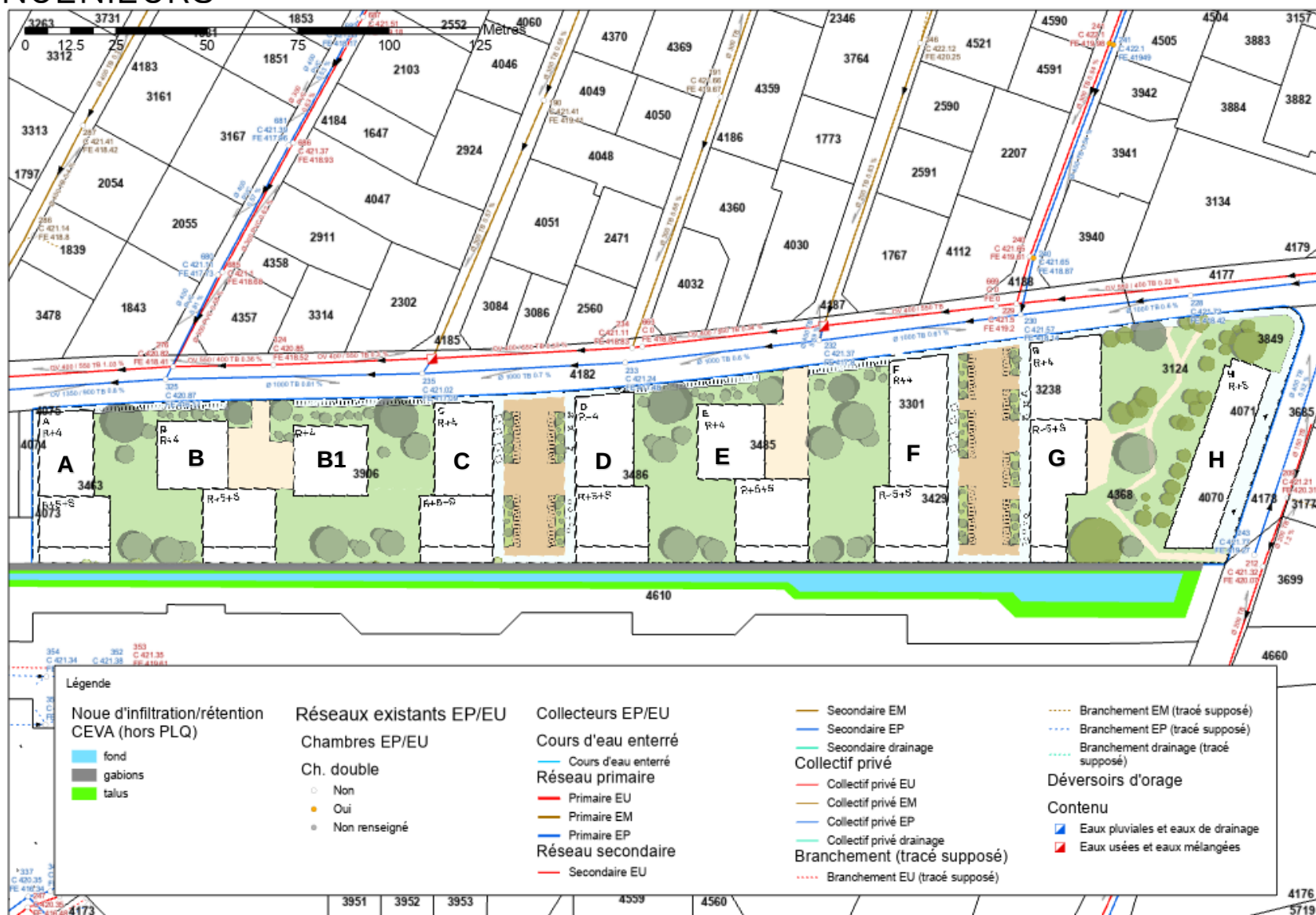
Figure 2 - Emprise du PLQ et réseaux existant
