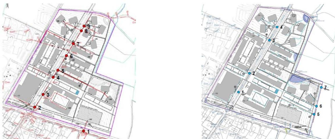
fig. 17– Image directrice du raccordement des réseaux d'eaux usées (à gauche) et d'eaux pluviales (à droite) des Grands Esserts sur le réseau public (extrait du cahier 7 gestion et évacuation des eaux – MOEU GP Grands Esserts 2013-2014 - novembre 2014)
