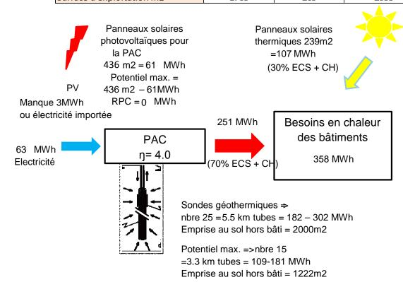
Une possibilité serait d'augmenter la surface de capteurs solaires à 554 m2 pour couvrir 70 % besoins CH et ECS. De ce fait, les sondes géothermiques couvriraient 30% des besoins.
