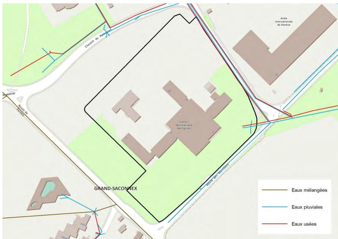
Figure 31 : Réseau d'évacuation des eaux
