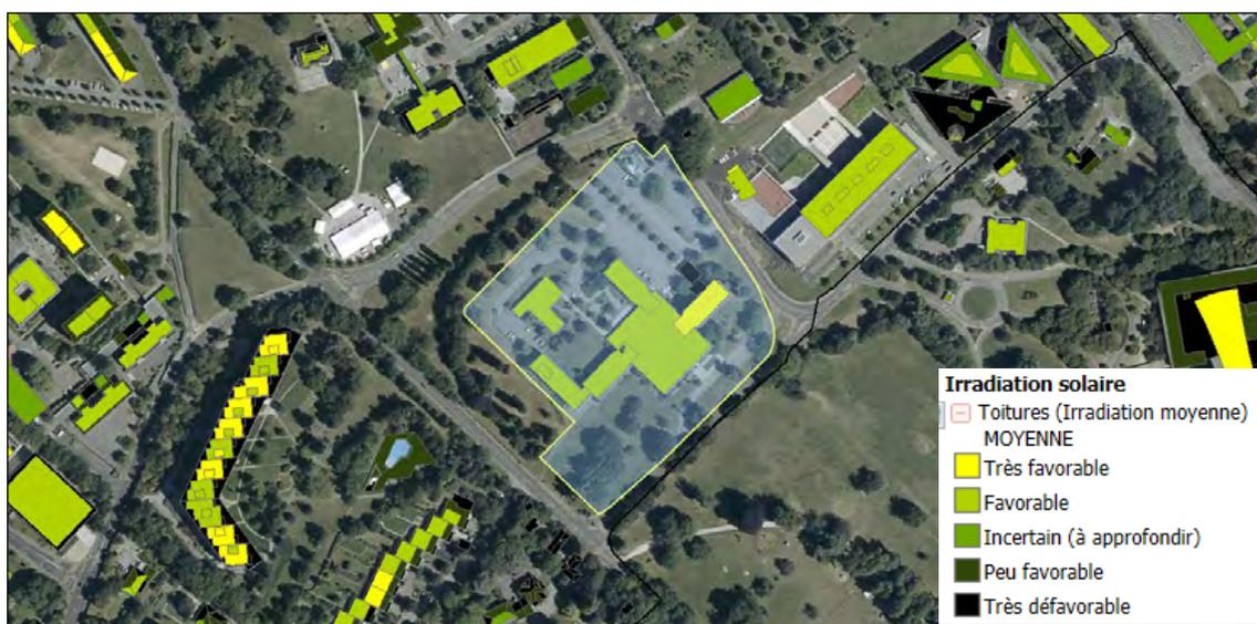
Figure 14 - Irradiation solaire moyenne sur les toitures du COE existant (source: SITG)
