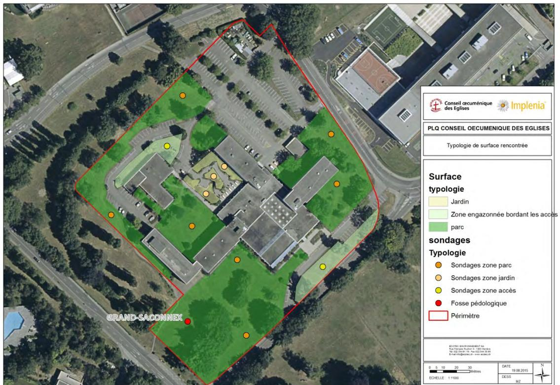
Figure 34 : Position des sondages.
