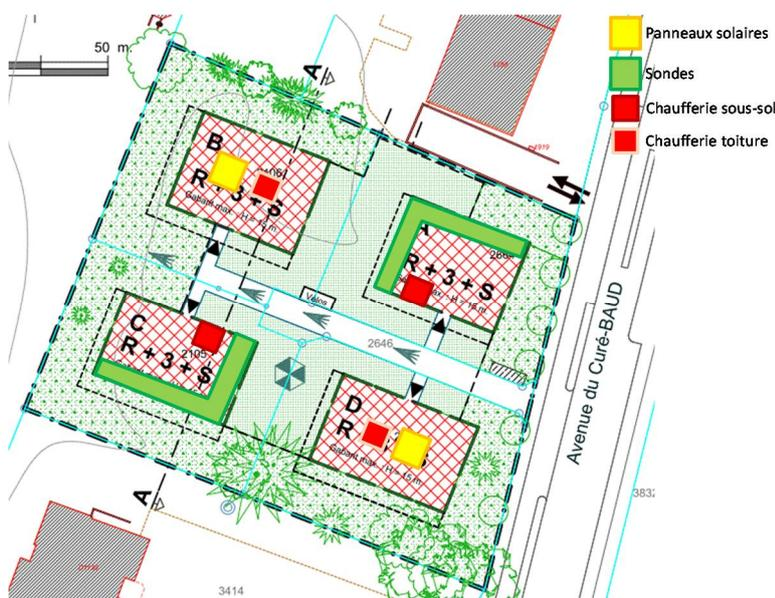
Figure 25 : Emplacement des réservations pour le scénario combiné « Géothermie » et « Air »
