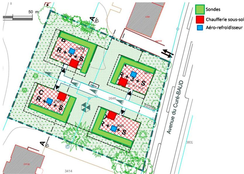
Figure 23 : Emplacement des réservations pour le scénario « Géothermie »
