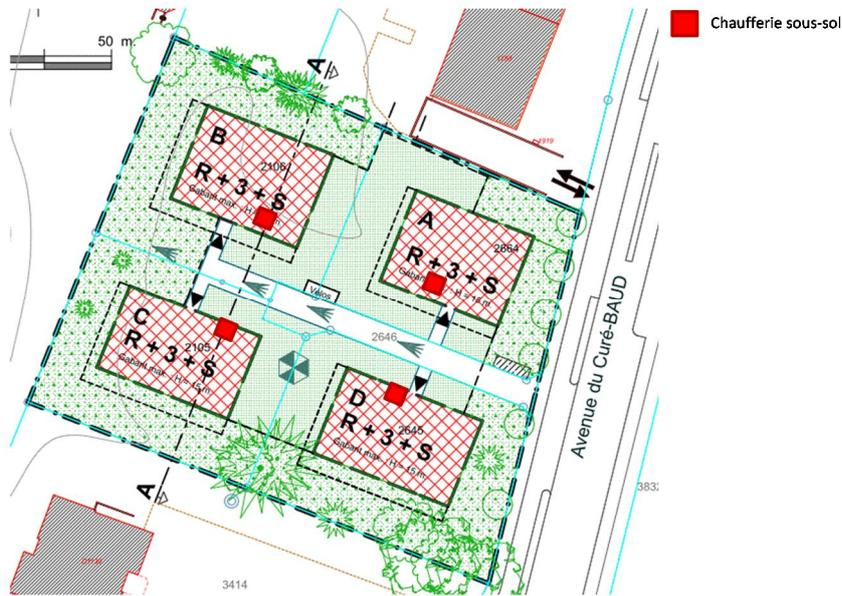
Figure 26 : Emplacement des réservations pour le scénario « CAD Palettes »
