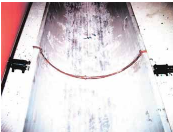
Figure 19 – Bandes de cuivre limitant la formation du biofilm.
