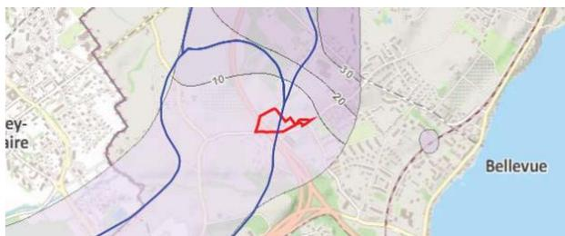
Figure 6.3.1.2 : Epaisseur de la couche d'argiles (retrait würmien). En bleu, l'étendu approximatif de la nappe de Montfleury. (Source: SITG)
