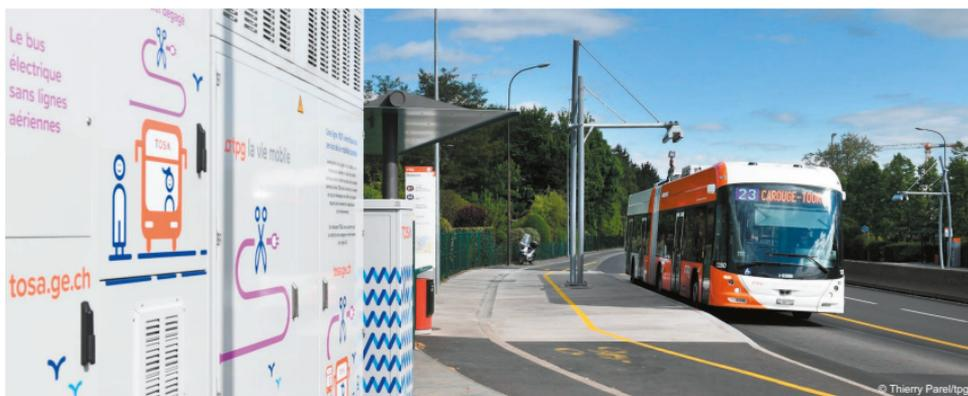
La technologie TOSA (Trolleybus Optimisation Système Alimentation) est une technologie de bus 100% électriques à biberonnage. Cela signifie que les bus n'évoluent pas en autonomie complète durant toute une journée de service mais qu'ils rechargent leurs batteries en cours de route, lors de l'arrêt à certaines stations spécifiquement équipées.
