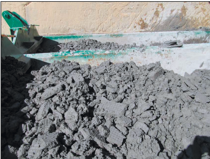
Fig. 7: Boues de lavage (cendres fines) en sortie de filtre-pressé
