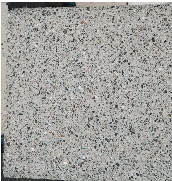
Fig. 11: Bloc de béton produit avec le sable de mâchefers issu du deuxième essai.
