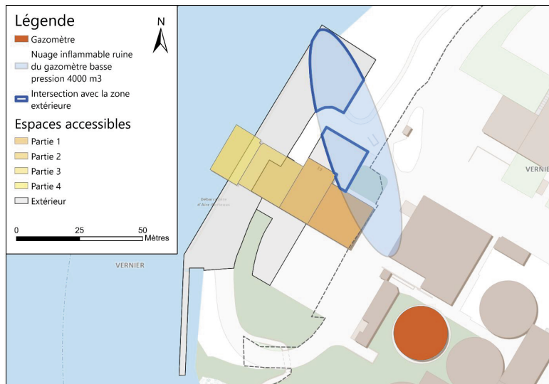
Figure 28 : Impact sur la zone extérieure - ruine du gazomètre basse pression 4000 m3 – 1F
