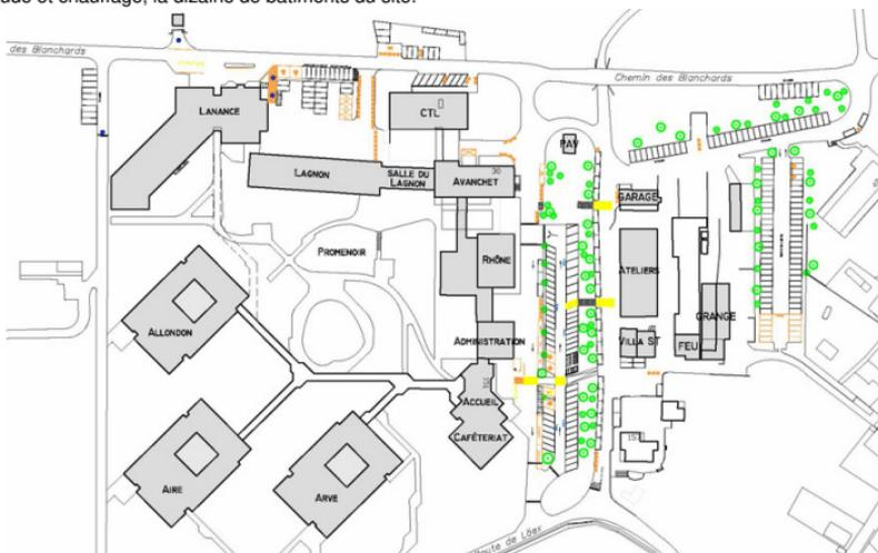
La production de chaleur est située dans le bâtiment CTL. Une boucle de chauffage à distance alimente les collecteurs de chauffage et les productions d'ECS des différents bâtiments, qui ne sont pas découplés par des échangeurs.
