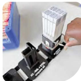
Conditionnement de 3 crayons dans une boîte et assemblage de 10 boîtes, décomposé en trois étapes réalisables avec une seule main grâce à l'outillage conçu par Jérôme Grosbéty.
