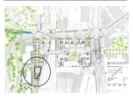
L'accès en vélo sera possible de part et d'autre de la route du Grand-Lancy. La rampe d'accès située au sortir du passage inférieur sud sera directement connectée avec la rampe d'accès au quai.
