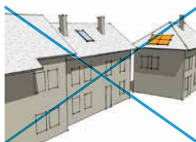
Ne respecte la géométrie de la toiture
