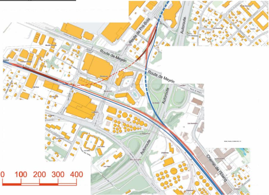
Le raccordement de Blandonnet, entre la ligne de l'aéroport et celle de La Plaine, s'enfoncé suffisamment profondément pour passer sous le carrefour Route de Meyrin – Route de Péré-Bois, et aussi sous l'angle du bâtiment du centre commercial de Blandonnet.
