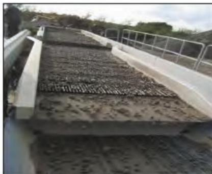
L'objectif de cette étape est d'homogénéiser les fractions de mâchefers à traiter afin d'optimiser les différentes étapes de tri en aval.
