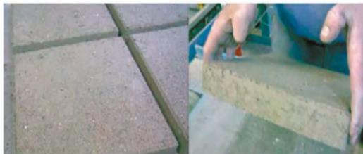
Blocs de béton créés à partir de mâchefers –Danemark
