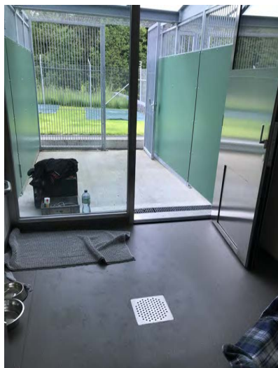
4. Box pour chien (intérieur et extérieur) Écoulements au sol, porte avec trappe et poignée anti-ouverture par les chiens, écran approprié entre les box extérieurs.
