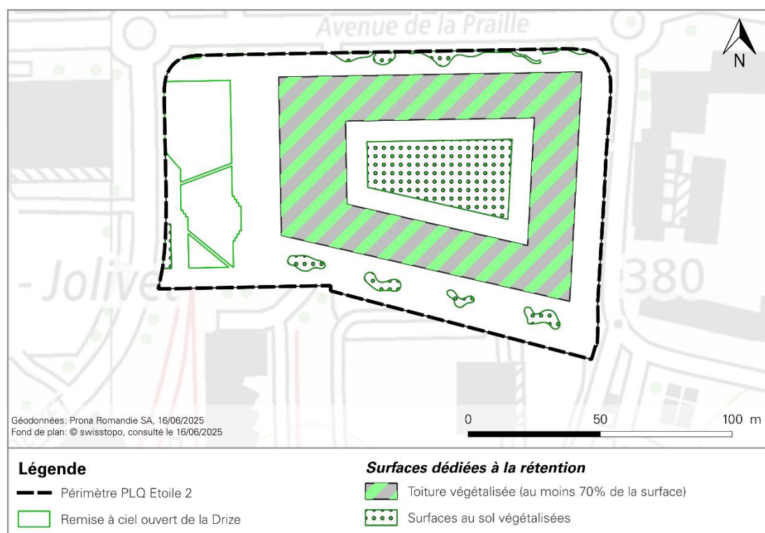
figure 19 Surfaces de rétention prévues
