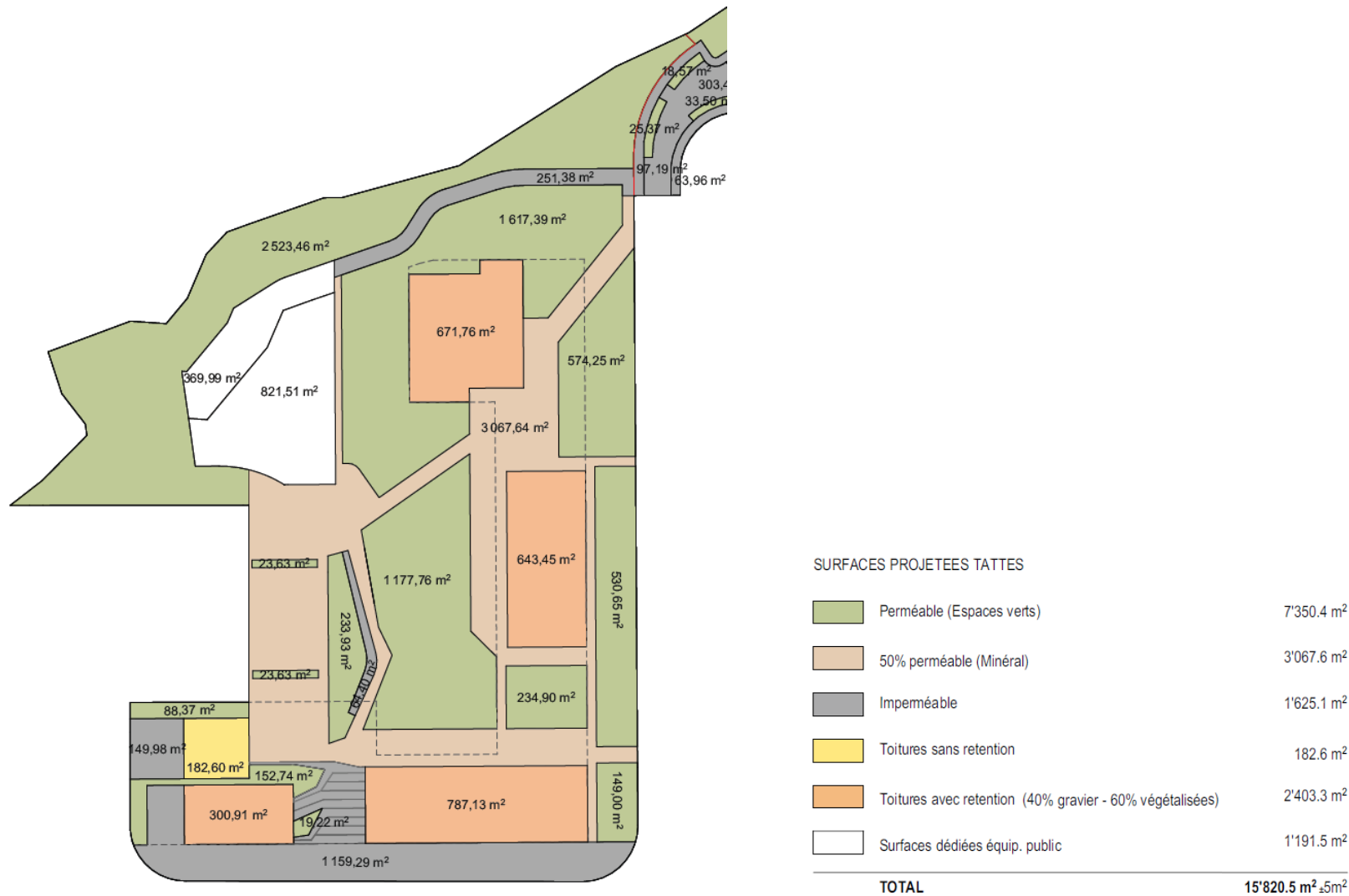
Figure 7 : Plan des perméabilités pour le bassin versant Tattes. Source : Fabio Fossati Architectes, mai 2025.
