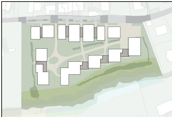
Les noues et bassins de rétention à ciel ouvert
