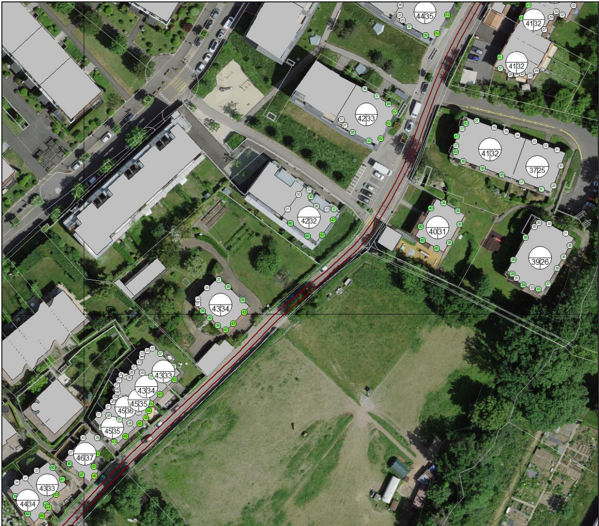
Figure 13 : Simulation acoustique – sans projet de PLQ 30'088 – Chemin de Lullin Ouest.
