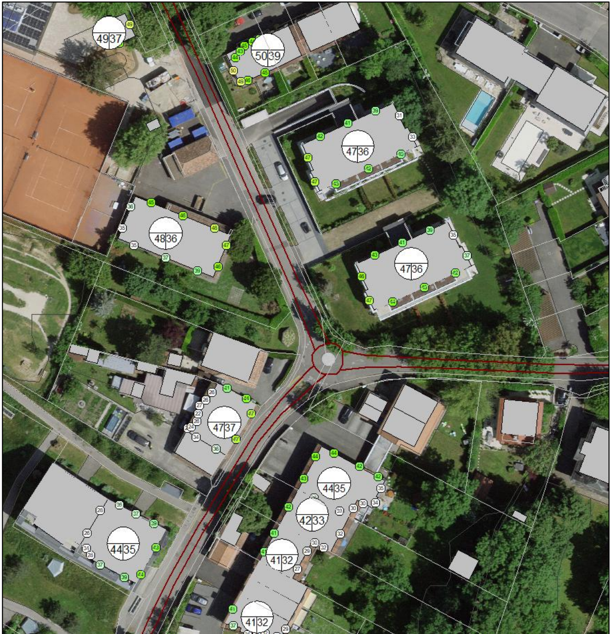
Figure 14 : Simulation acoustique – sans projet de PLQ 30'088 – Chemin de Lullin Est.
