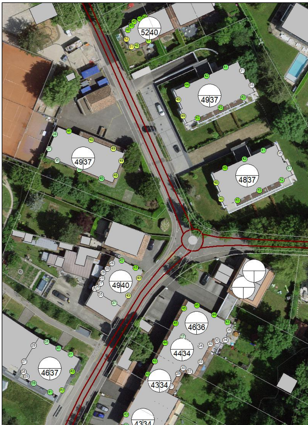
Figure 18 : Simulation acoustique – avec projet de PLQ 30'088 – Chemin de Lullin Est.
