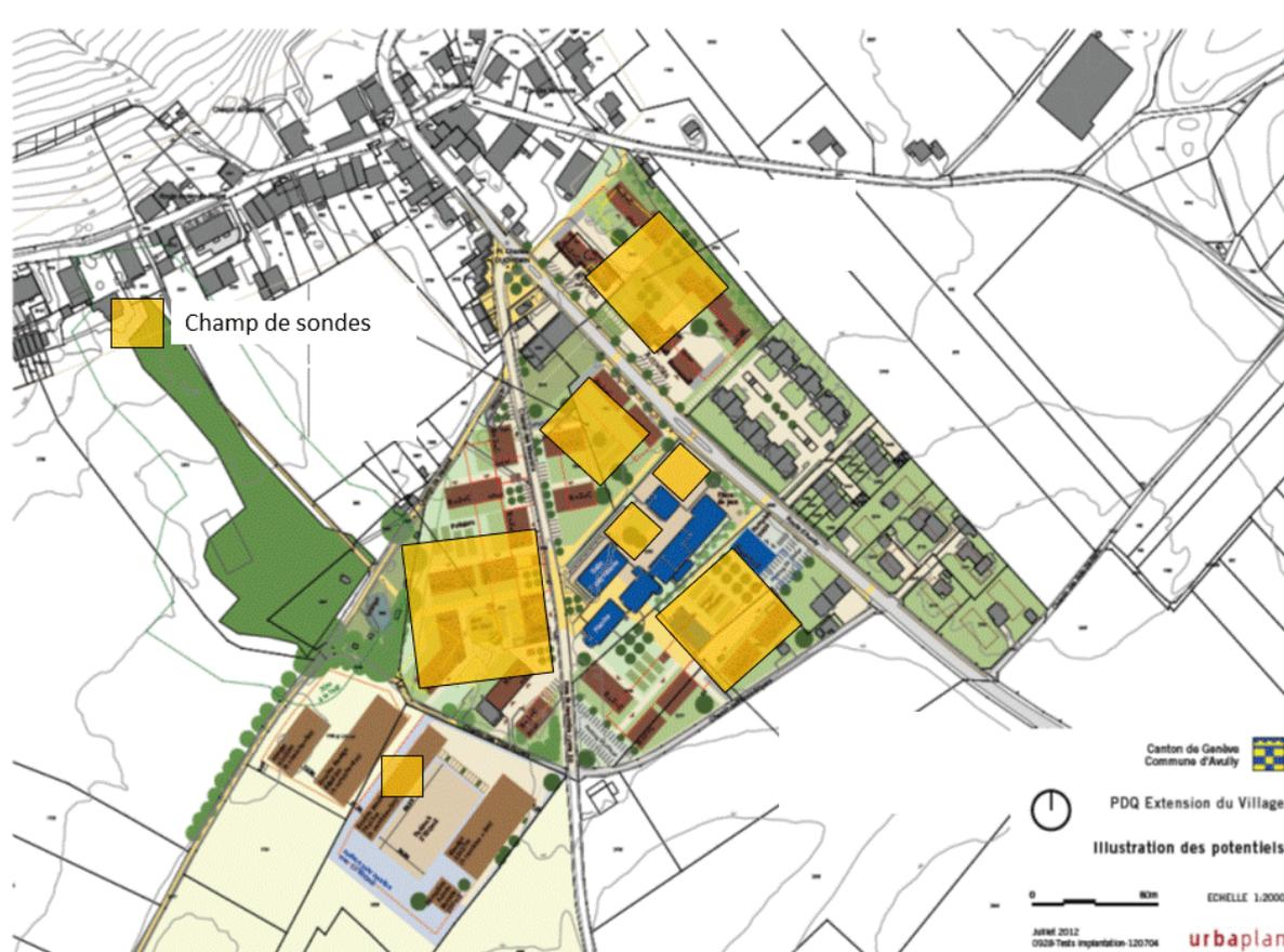
**Figure 12** : implantation de champ de sondes géothermiques verticales dans les secteurs à bâtir
