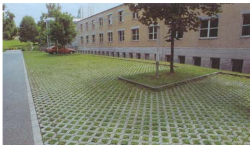
Parking avec revêtement perméable
