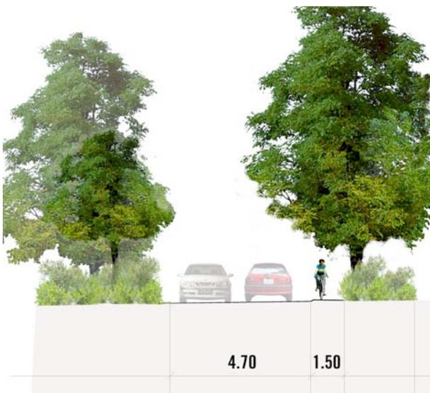
**Figure 81:** Coupe de principe : aménagement chemin piéton-cycle sur la route du Moulin-Roget. Le léger rétrécissement de la route marque l'arrivée dans le village. Le trottoir large de 2.50m assure le confort des piétons et vélos.
