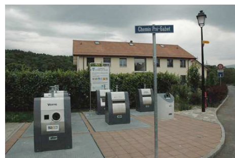
Containers enterrés à Aire-la-Ville.
