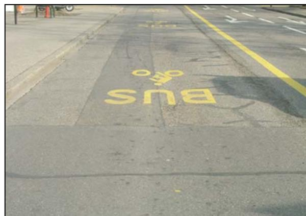
La voie mixte bus/vélos sans sur largeur est en principe aménagée en descente et lorsque la voie bus est peu sollicitée (lignes peu nombreuses, faible fréquence). Dans les autres cas, la voie mixte ne devrait être envisagée que sur une courte distance ou avec une sur largeur d'au moins 1.50 m. pour permettre le dépassement par le bus.
