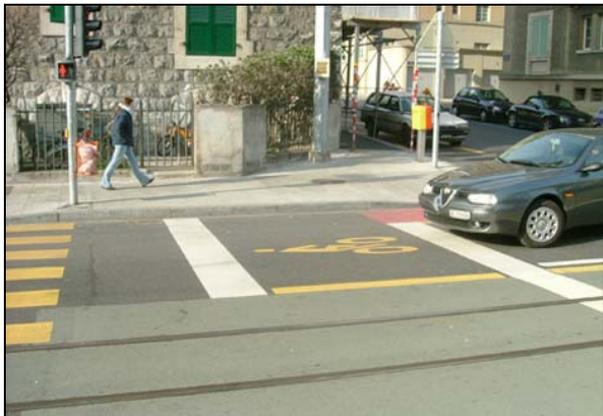
La case avancée est conseillée devant les présélections de tourner-à-gauche et à double direction (en particulier lorsque les flux principaux ne sont pas les mêmes entre le trafic général et les deux-roues légers). Ce type d'aménagement est plus efficace lorsque le feu rouge est long.
