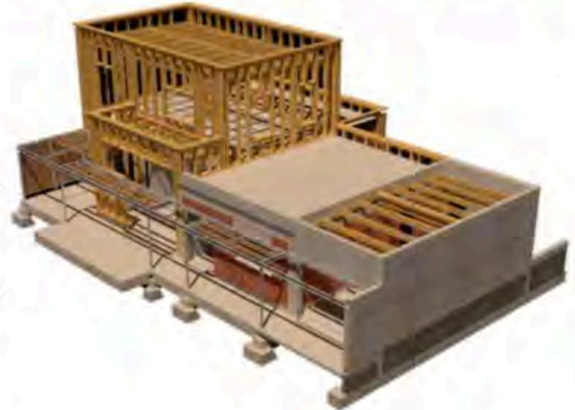
Chaque mur, dalle, cloison, élément de charpente, appuis de fenêtre, appareil sanitaire, interrupteur est un objet 3D intelligent quantifiable et exportable au format IFC. L'intégralité de ces objets possède un attribut qui est lié à un logiciel d'économie pour une estimation des coûts en temps réel.
