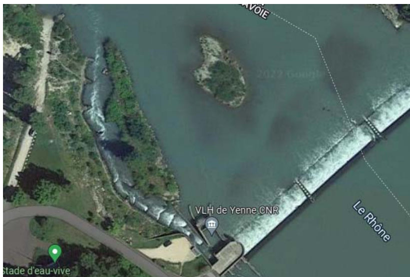
Rivière de contournement compatible avec la navigation. Bassin d'eau vive (Yenne, France)
