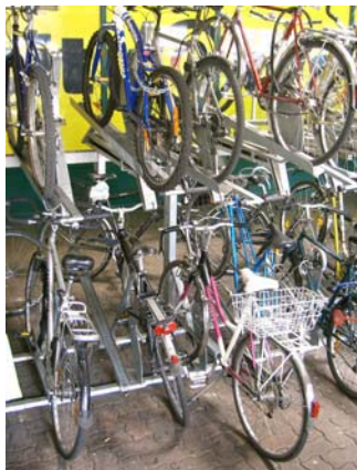
Figure 5: Râteliers à deux étages. Solution compacte, mais sensible au vandalisme, peu tolérante aux vélos non-conformes (trop grands, avec paniers ou sièges enfants).
