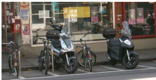
Figure 5: Un écartement de 1m entre deux épingles n'empêche pas un scooter d'y stationner (24, bd Carl-VOGT, Juillet 2007)
