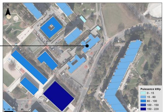
Figure 8 : exemple de cartes thématiques aux trois échelles du rendu – surface utile (ratio kWh électrique annuel produit / m<sup>2</sup> capteur installé), surface de base (MWh électrique produits annuellement), bâtiment (puissance totale installée) – et d'infos bulle pour un objet donné (en bleu les indicateurs principaux, en gris les indicateurs spécifiques).
