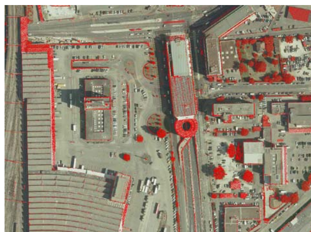
Figure 17 : Illustration de la classification imparfaite des points LiDAR sur la végétation (points rouge sur la photo, La Praille-Genève).
